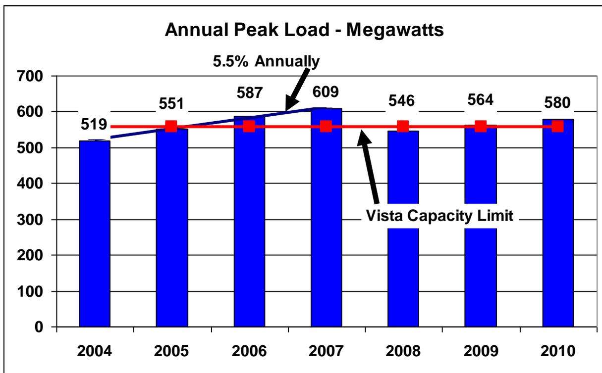
**FIGURE 1.5-2. PROJECTED RPU PEAK LOAD**
